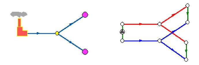
На расчетной схеме красным цветом условно обозначены участки подающего трубопровода, синим - обратного, зеленым - участки соединяющие подающий и обратный трубопроводы. Источник изображен участком со стрелкой в кружке. Так будем изображать участки на которых действует устройство, повышающее давление (например, насос).
