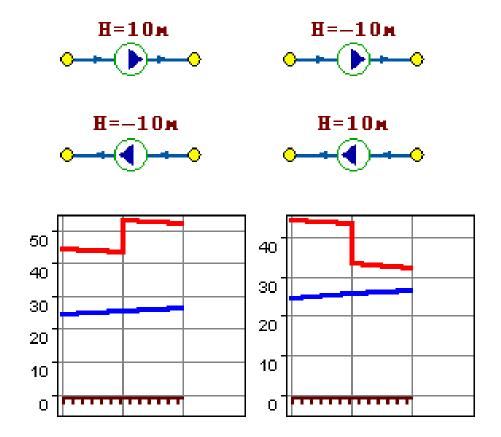
На рисунке видно, как различные направления участков, входящих и выходящих из насоса в сочетании с разными знаками напора на насосе влияют на результат расчета, отображенный на пьезометрических графиках.
