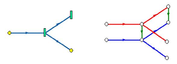
Так как перемычка в однолинейном изображении представлена узлом, то для моделирования соединения между подающим трубопроводом одного участка и обратным трубопроводом другого участка одного элемента «перемычка» недостаточно. Понадобятся еще два участка: один только подающий, другой - только обратный.
