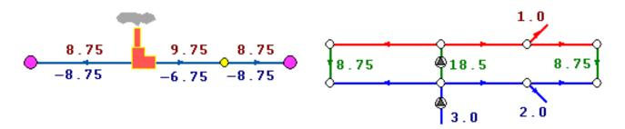
Если на одну сеть работает несколько источников, то в общем случае только на одном из источников с подпиткой можно одновременно поддерживать и давление в обратном трубопроводе и располагаемый напор на выходе. У остальных источников с подпиткой можно поддерживать только давление в обратном трубопроводе.
